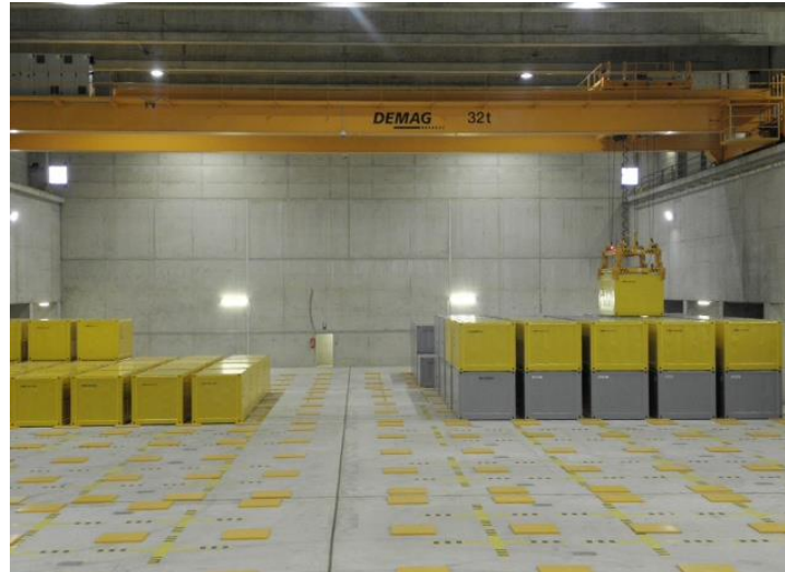
Abb. 7: Containerhandhabung mit dem Kran
